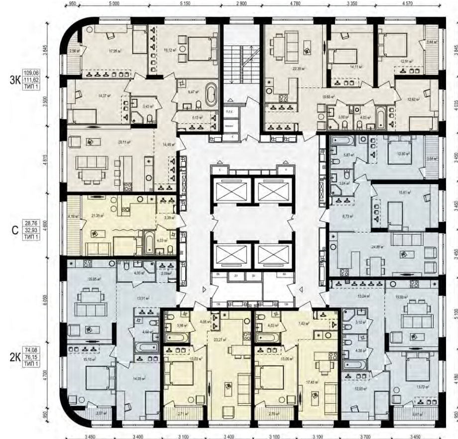
Дом №2. План типового этажа
