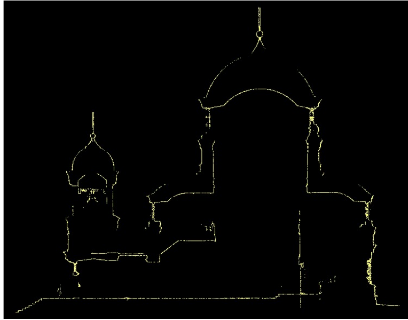
Рис. 11. Продольный разрез храма А. Невского, полученный путем «среза» из «облака точек»
