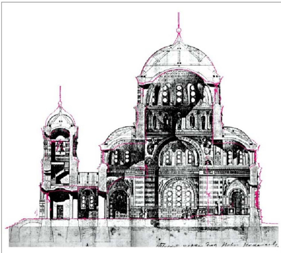
Рис. 12. Сопоставление проектного чертежа с обмерами
