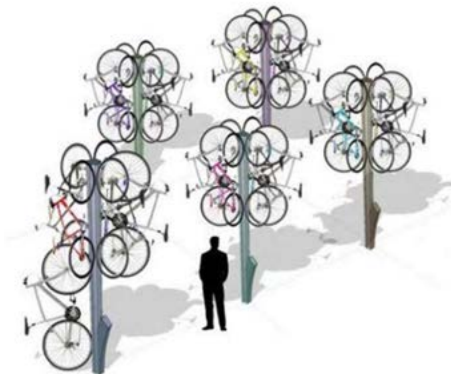
Рис. 192. Механизированная вертикальная велопарковка с доступом с электронным ключом.
