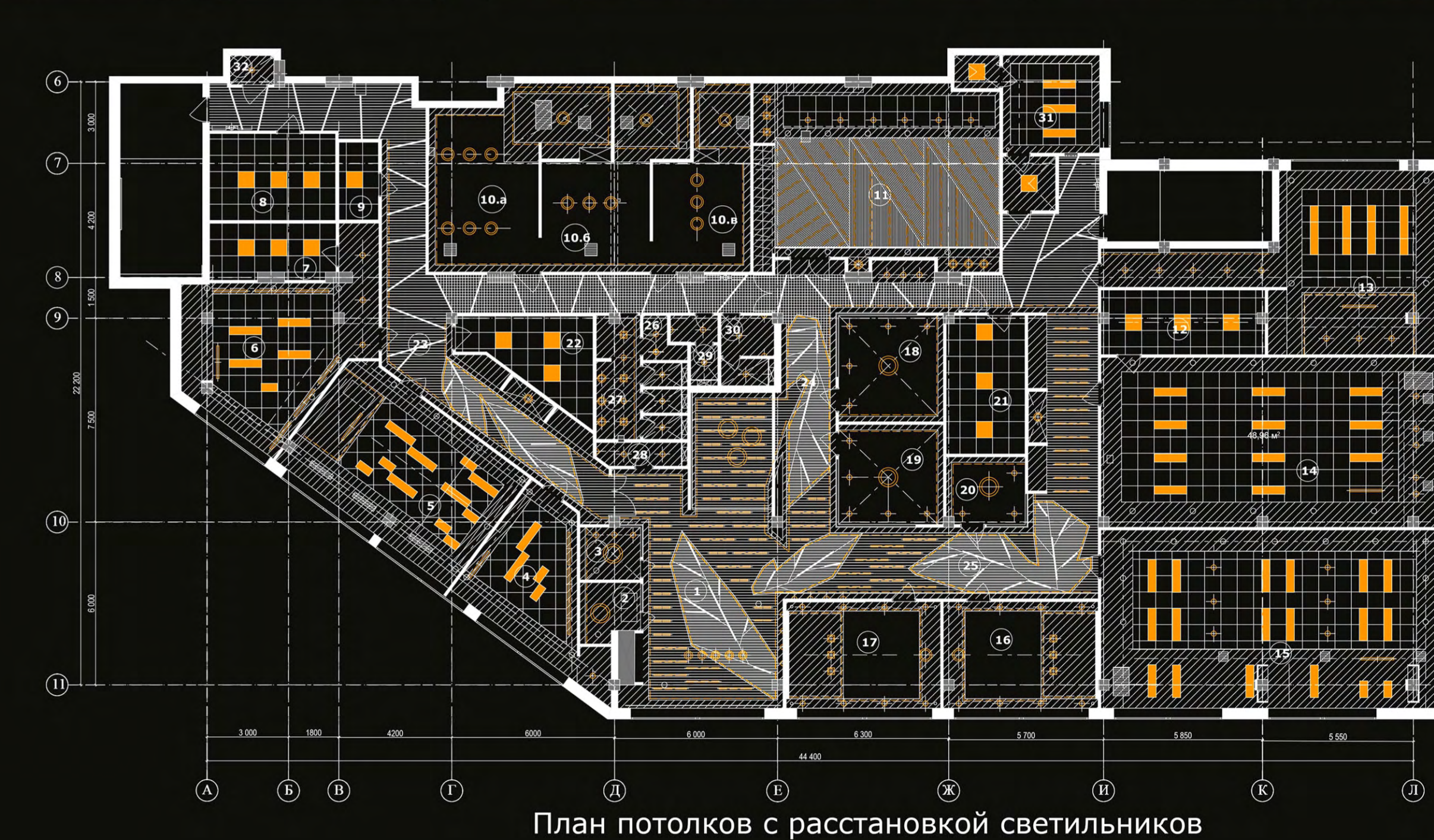
План потолков с расстановкой светильников
